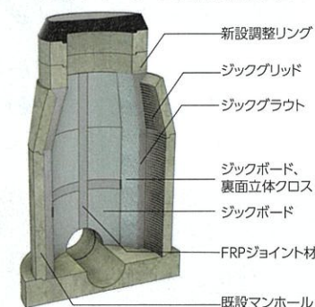
自立マンホール更生工法 「ジックボードJ工法」仕様積層図
